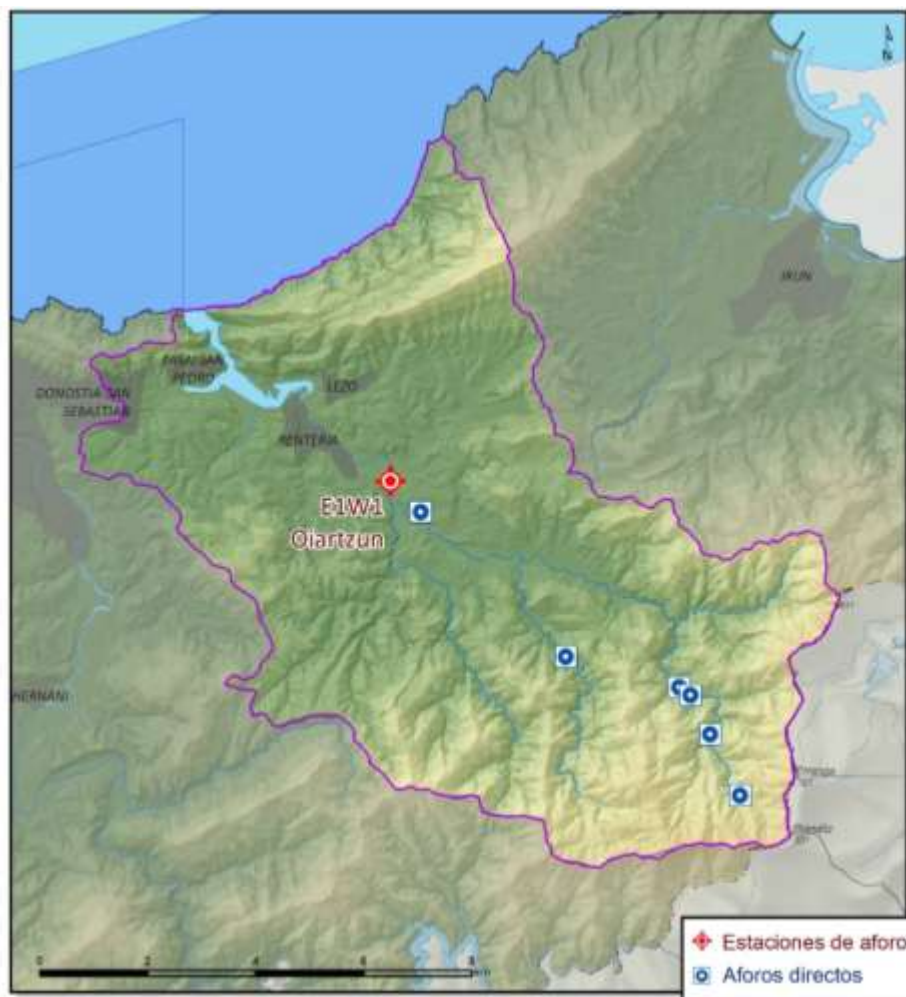
Figura 2 Ubicación de la estación de aforo y los afloramientos directos realizados en la Unidad Hidrológica Oiartzun. Tal y como se describe en la siguiente tabla, en la estación de aforo E1W1 Oiartzun, se cumple el caudal ecológico todos los días en los que dispone de información de aforo.
